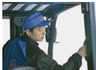
► Ein optionaler Hilfsgriff für die hintere Säule mit einem Hupenknopf erhöht die Sicherheit des Bedieners beim Rückwärtsfahren.
