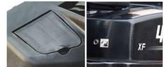
► Die Abdeckung des Panels kann zur Überprüfung der Bremsflüssigkeit leicht angehoben werden.
