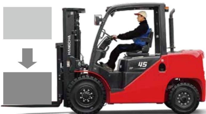
► Das Anwesenheitserfassungssystem des Fahrers umfasst eine Hebe/Kipp- und Fahrsperrfunktion. Wenn der Fahrer den Sitz verlässt, sperrt das System automatisch das Heben/Kippen und deaktiviert die Bewegung, um die Sicherheit zu gewährleisten.
